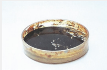
„Ölverunreinigte Wasserober- fläche“, 20.000 mg/l
